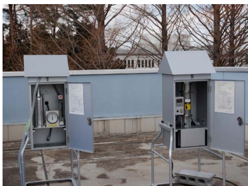
図 1-1-1 ハイポリウムエアサンプラー（右）及びアンダーセン型サンプラー（左）による 大気試料採取
