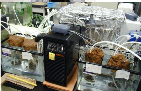
飼育実験（流水式連続曝露試験）
